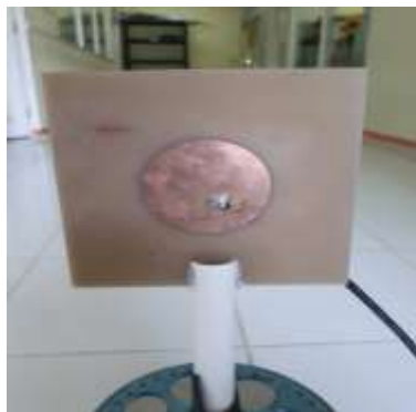
Gambar 5 Hasil pabrikasi antenna mikrostrip patch lingkaran
