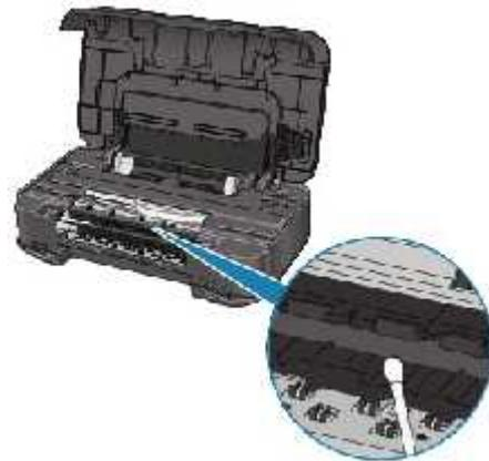
Gambar 2 Membersihkan bagian dalam printer
