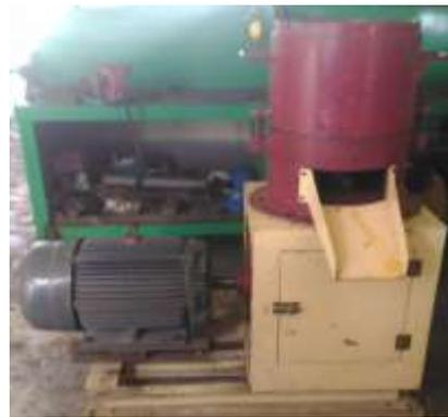
Gambar 3. Mesin Pencetak *Wood Pellet*
