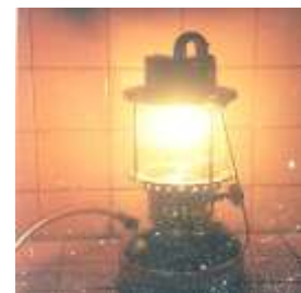
Gambar 13. Hasil modifikasi lampu petromak menjadi lampu biogas
