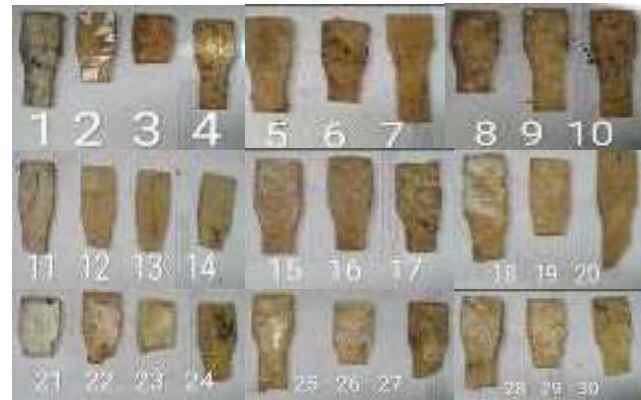
Gambar 4.11 Hasil pengamatan Biodegradasi selama 3 minggu
