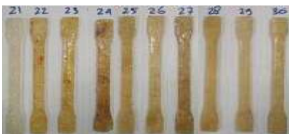
Gambar 3. formulasi PLA /PCL dengan penambahan bentonit dan kitosan
