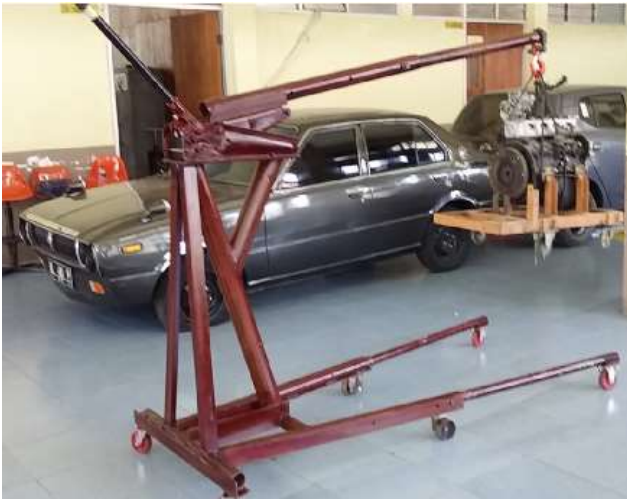
Gambar 4. Alat bantu pengangkat mesin mobil.
