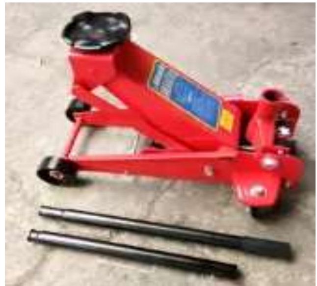
Gambar 2. Dongkrak buaya hydraulic. (Sumber : https://www.klikteknik.com/blog/macam-macam-dongkrak-dan-fungsinya.html [5])
