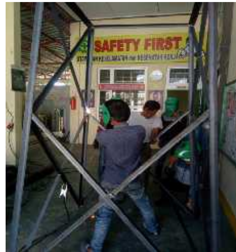
Gambar 5. Peserta training melakukan dibawah pengawasan instruktur dan ketua pelaksana IbM sedang mengelas kontruksi tower air dengan kapasitas 1000 liter
