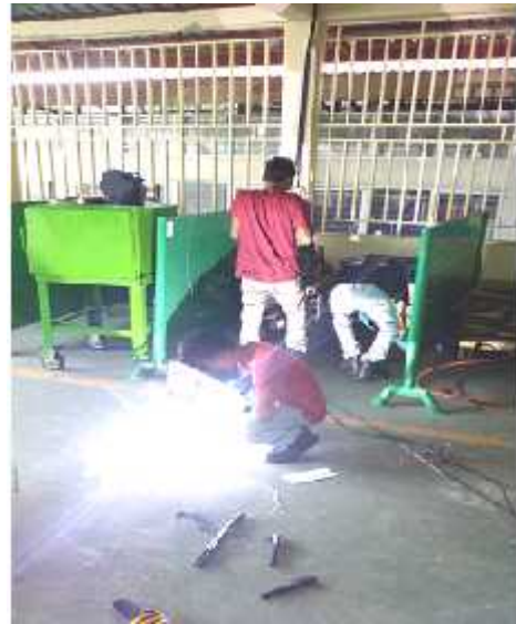
Gambar 4. Peserta training melakukan sedang melakukan praktek pengelasan tack weld dan fillet weld
