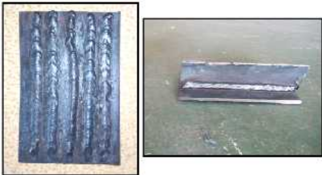
Gambar 7. Hasil praktek tack weld dan praktek fillet weld oleh peserta training
